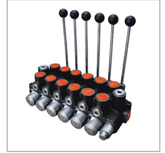
Dilimli Valfler Debi 70 - 120 lt / dk Çalışma Basıncı 920 bar
